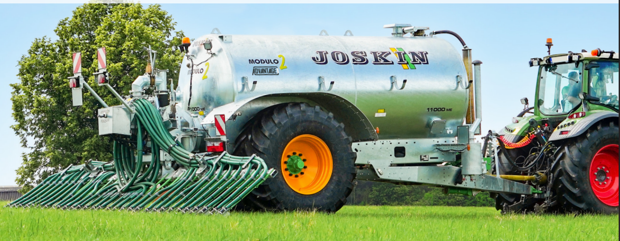
Radkasteneinbau: Bereifung 800/65R32
